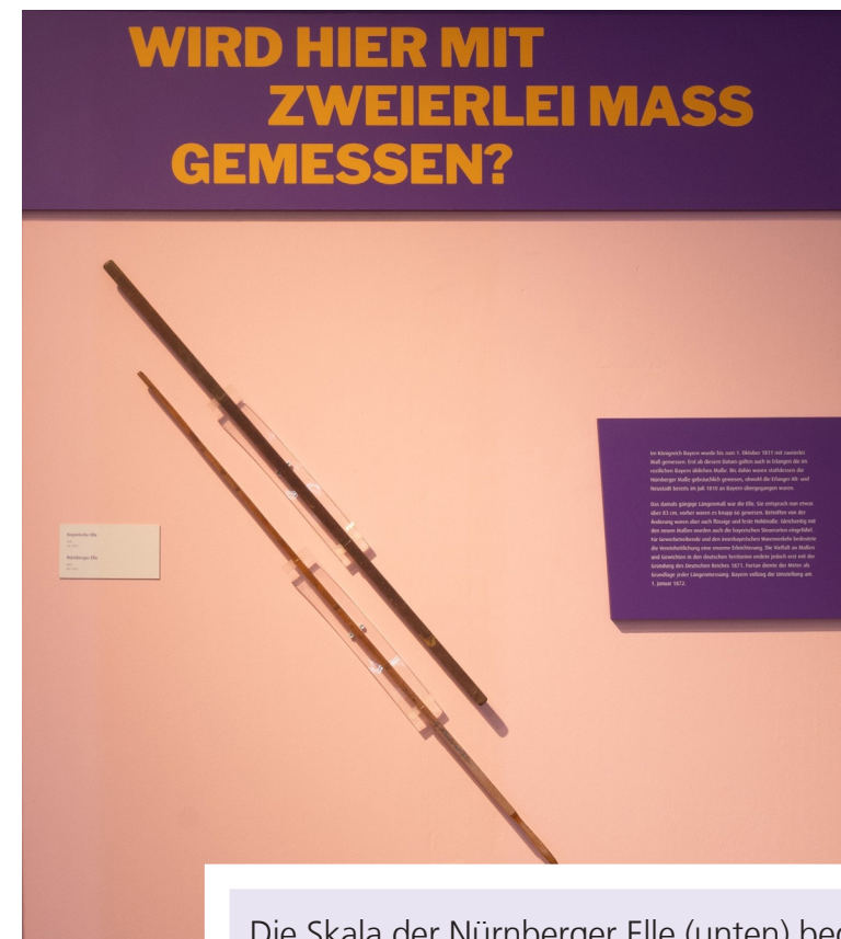
Die Skala der Nürnberger Elle (unten) beginnt erst ein gutes Stück oberhalb des Griffes und ist daher tatsächlich rund 17 cm kürzer als die der bayerischen Elle (oben)
